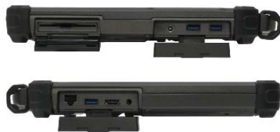
Portar och anslutningar under väl skyddande lock
